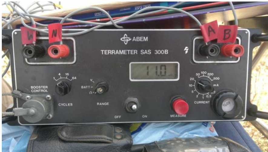
الشكل (3): جهاز المسح الكهربائي (Terrameter SAS 300B) المستخدم في العمل الحقل
